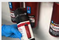
3. Reemplace el filtro de repuesto
