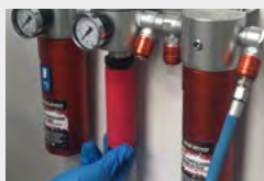
2. Desenrosque el filtro usado
